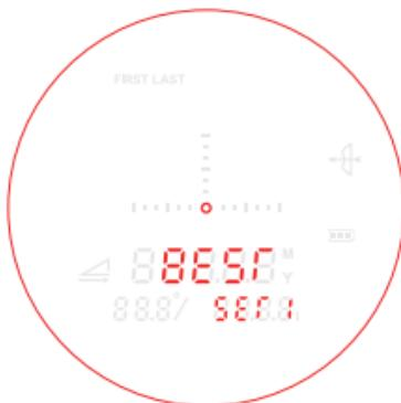
Dieser Modus wird empfohlen, wenn sich keine offensichtlichen Hindernisse vor dem Ziel befinden und keine signifikanten Störungen durch den Hintergrund vorliegen. Er bietet eine Reichweite von bis zu 2.000 Yards für die meisten Ziele, die unter normalen Messbedingungen eine mittlere Reflektivität aufweisen.
