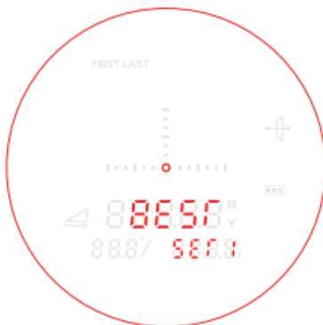
Este modo se recomienda cuando no hay obstrucciones evidentes frente al objetivo y no hay interferencias significativas del fondo. Ofrece un rango de medición de hasta 2.000 yardas para la mayoría de los objetivos, que bajo condiciones normales de medición tienen una reflectividad media.
