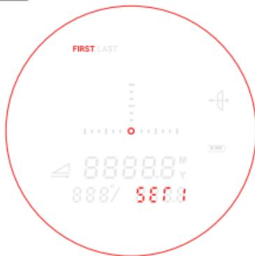
Dieser Modus ermöglicht es, Entfernungen zu kleinen Zielen und Wildtieren leicht zu erfassen, ohne versehentlich die Entfernung zu Hintergrundzielen zu erhalten, da Hintergrundziele ein stärkeres Signal haben. Beim Locken auf mehrere Ziele wird nur die Entfernung zum nächstgelegenen Ziel angezeigt. In diesem Modus richten Sie das Fadenkreuz auf das
