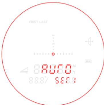
Ce mode permet de mesurer simultanément les distances des cibles les plus proches et les plus éloignées.
