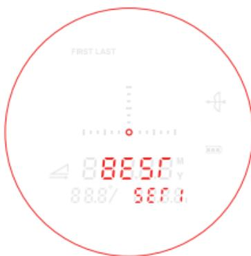
Ce mode est recommandé lorsqu'il n'y a pas d'obstacles évidents devant la cible et qu'il n'y a pas d'interférences significatives avec l'arrière-plan. Il offre une portée de mesure allant jusqu'à 2 000 mètres pour la plupart des cibles qui, dans des conditions de portée normales, ont une réflectivité moyenne.
