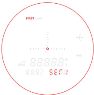
Ce mode permet d'obtenir facilement les distances des petites cibles et du gibier sans obtenir accidentellement la distance des cibles d'arrière-plan, car ces dernières ont un signal plus fort. En cas de verrouillage sur plusieurs cibles, seule la distance avec la cible la plus proche sera affichée. Dans ce mode, alignez le réticule sur la cible que vous
