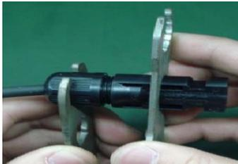
Schritt 4: Überprüfen Sie die richtige Polarität des Verbindungskabels von PV-Modulen und PV-Eingangsanschlüssen. Verbinden Sie dann den Pluspol (+) des Anschlusskabels mit dem Pluspol (+) des PV-Eingangssteckers. Minuspol (-) des Anschlusskabels mit Minuspol (-) des PV-Eingangssteckers verbinden.
