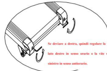
Se deviare a destra, quindi regolare la vite sul lato destro in senso orario e la vite sul lato sinistro in senso antiorario.
