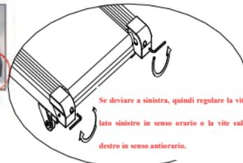
Se deviare a sinistra, quindi regolare la vite sul lato sinistro in senso orario e la vite sul lato destro in senso antiorario.
