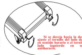
Si se desvía hacia la derecha, ajuste el tornillo del lado derecho en sentido horario o el tornillo del lado izquierdo en sentido antihorario.
