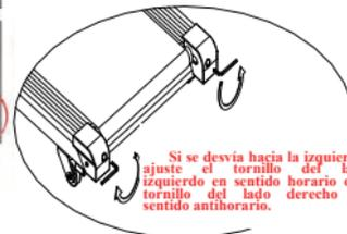
Si se desvía hacia la izquierda, ajuste el tornillo del lado izquierdo en sentido horario o el tornillo del lado derecho en sentido antihorario.
